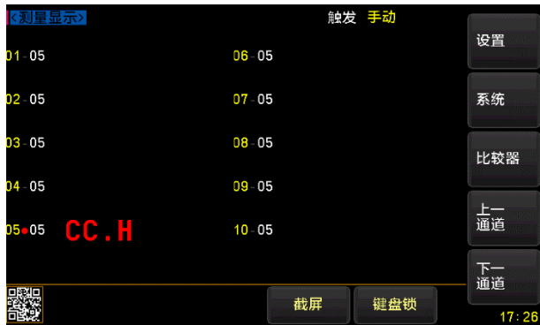
图 6-2 HIGH (+) 端测试线接触不良
