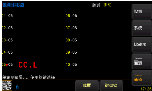
图 6-3 LOW (-) 端测试线接触不良
