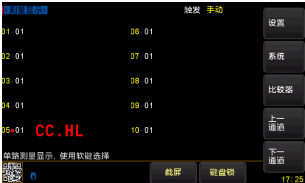
图 6-1 测试线全部接触不良
